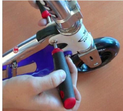
Für den Austausch des Klappmechanismus müssen Sie die obere Schraube mit einem 5 mm Inbusschlüssel lösen und entnehmen. Bitte beachten Sie dabei, dass der Klappmechanismus nicht unter Spannung steht.
