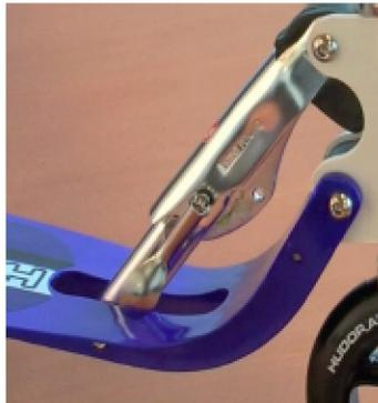
Der neue Klappmechanismus kann nun eingesetzt werden.
