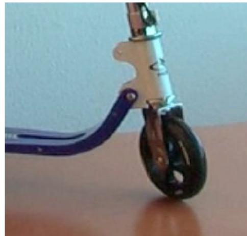
Als nächstes setzen Sie die Seegerringezange am Seegerring an und ziehen den Ring über den Bolzen ab.
